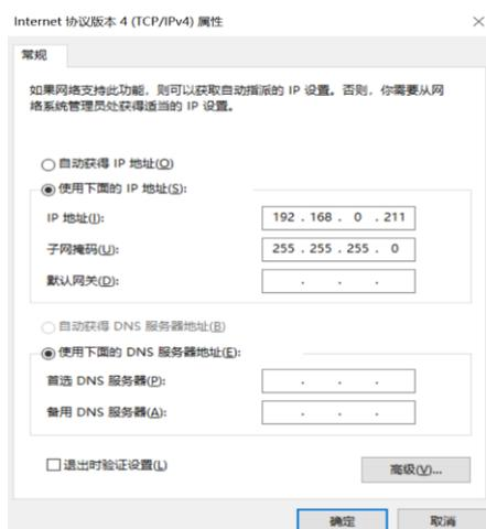
图 1.2-1：修改电脑网卡 IP 图示
