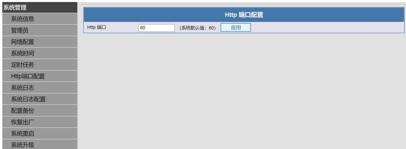
图 2.6-1: Http 端口配置设置
