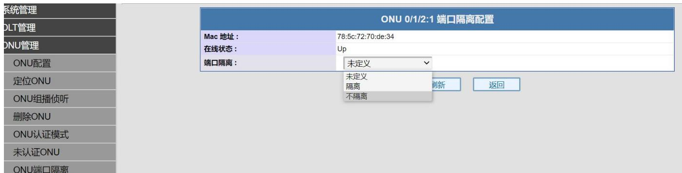
图 4.7-1: ONU 端口隔离设置
