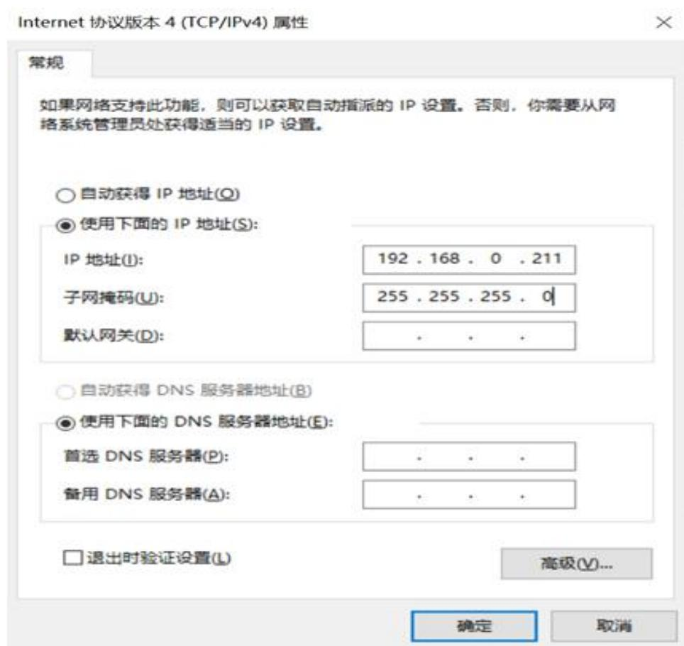
图 1.1-1：修改电脑网卡 IP 图示
