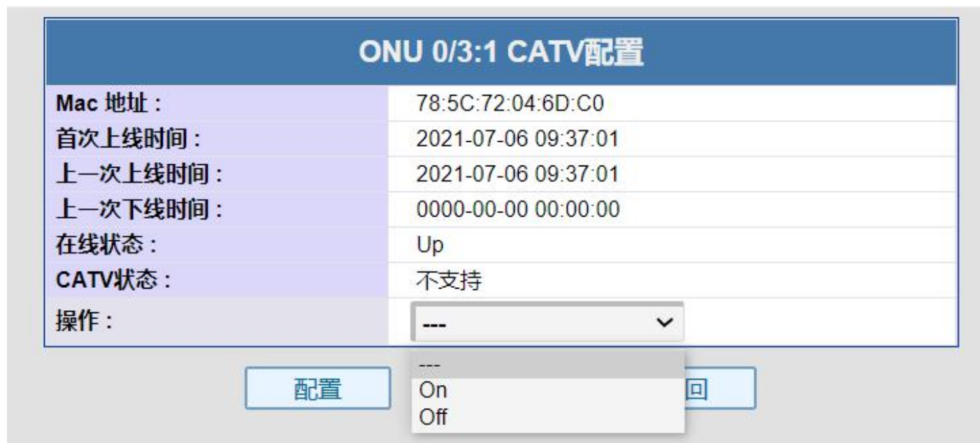
图 3.6-1: ONU CATV 配置
