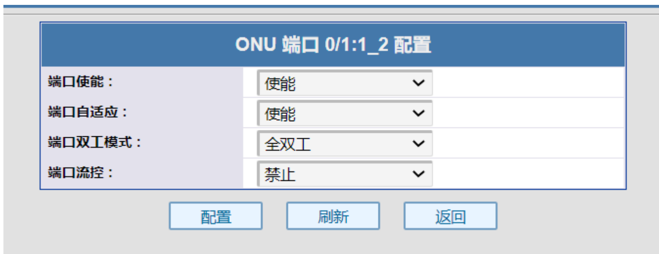
图 4.3-2: ONU 端口配置修改
