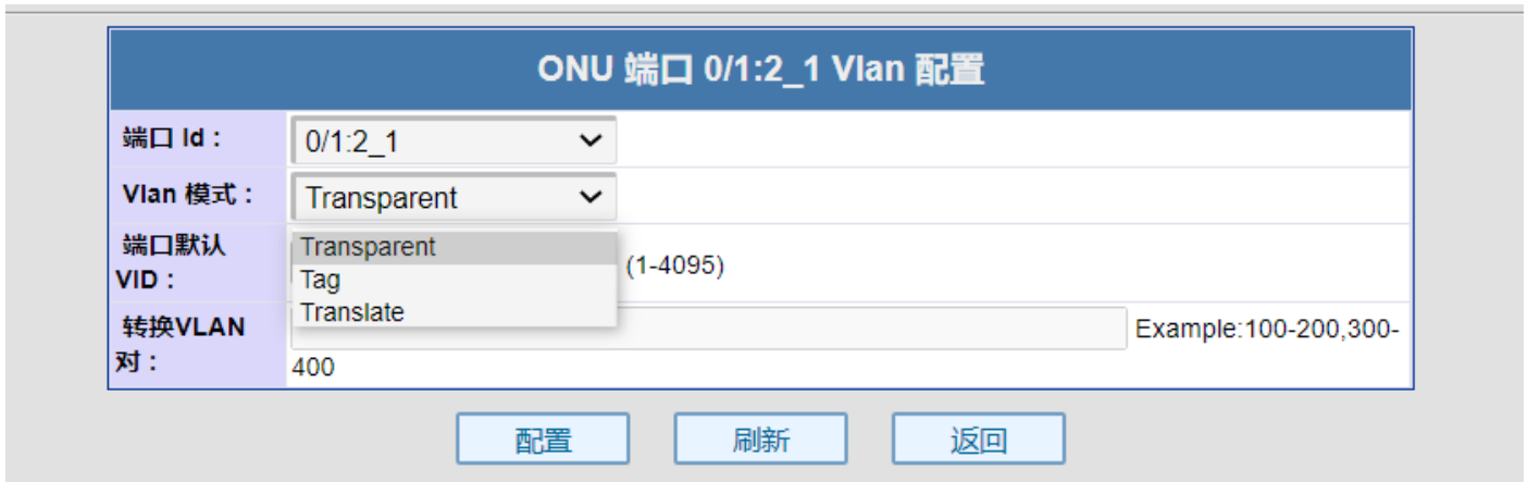
图 6.1-1：ONU 端口 Vlan 划分
