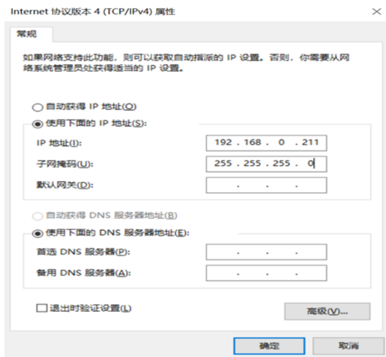
图 1.1-1: 修改电脑网卡 IP 图示
